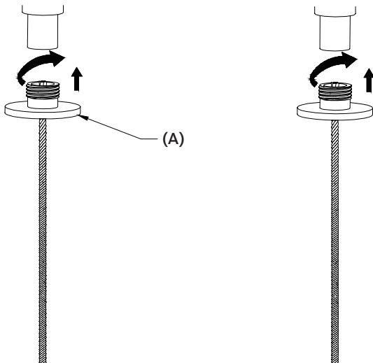
**4:** Nach Festlegen der Montagehöhe, führen Sie das Stahlseil durch das Festigungsschloss und drehen den Gewindezapfen im Uhrzeigersinn in die Befestigungsplatte bis zum Anschlag fest.
