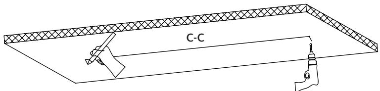
**2:** Fügen Sie die Montageschrauben ein und befestigen Sie anschließend die Kunststoffhalter mittels beiliegender Schrauben.
