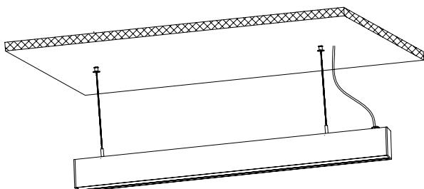
**6:** Schließen Sie die Eingangsleitung gemäß der Abbildung unten an. Wenn der Stecker nicht benötigt wird, schneiden Sie das Kabel ab und beenden Sie die Installation. Dies hat keine Auswirkung auf die Garantie.
