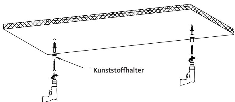
**3:** Führen Sie das Stahlseil in den Kunststoffstopfen ein und drehen Sie den Stopfen gegen den Uhrzeigersinn in dem Kunststoffhalter fest (A).
