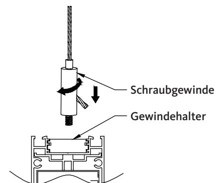
**5:** Passen Sie die Kabellängen nach Bedarf an und stellen Sie sicher, dass die Halterung waagerecht ausgerichtet ist.
