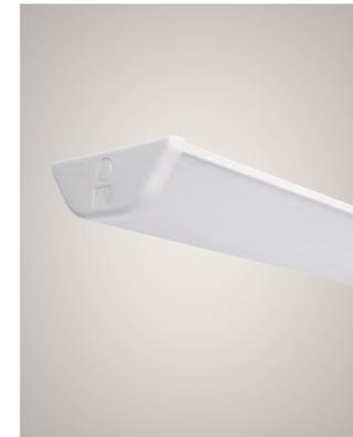
Z44 S ist eine vielseitige, energieeffiziente IP44-Leuchte für alle Innenräume, die einen höheren IP-Schutz benötigen. Der mattierte prismatische Diffusor sorgt für eine gleichmäßige und blendfreie Beleuchtung. Die Z44S ist neben der klassischen Leuchte auch als Automatikleuchte verfügbar. Der integrierte HF-Bewegungsmelder kann werkseitig mit drei unterschiedlichen Lichtszenen vorprogrammiert werden, die leicht durch den Anwender geändert werden können.
