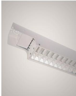
Sarek Sport ist eine leistungsstarke, ballwurfsichere (geprüft nach DIN 18032-3) Leuchte mit hoher Effizienz und hohem Lichtstrom. Das Gehäuse (RAL 9010) ist aus korrosionsgeschütztem, aluzink-beschichtetem Stahlblech gefertigt und gewährleistet eine lange Lebensdauer. Das robuste Lamellenraster in Kombination mit dem diffusen Reflektor MIRO 5 und dem Mikroprismendiffusor aus Acrylglas sorgt für eine hervorragende, blendungsarme Ausleuchtung bei allen Sportarten.
