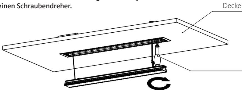
Mittels Drehen im Uhrzeigersinn werden die Halter nun über die Öffnung bewegt und halten die Leuchte. Durch weiteres Drehen im Uhrzeigersinn der Schrauben erhält die Leuchte einen festen Sitz.
