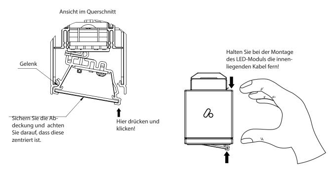
6: Nach der Montage, die Optik in die Mitte bringen (Ohne Lichtspalte). An den Enden die Abdeckungen anbringen (bei opalen und mikroprismatischen Versionen)
