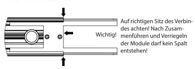
3 a: Montieren Sie das Startmodul gemäß der Anleitung für Sevede Ceiling/PE Standard.
