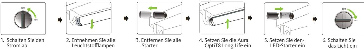
Beachten Sie bitte bei der Installation, den installierten Starter durch einen LED-Starter zu ersetzen..
