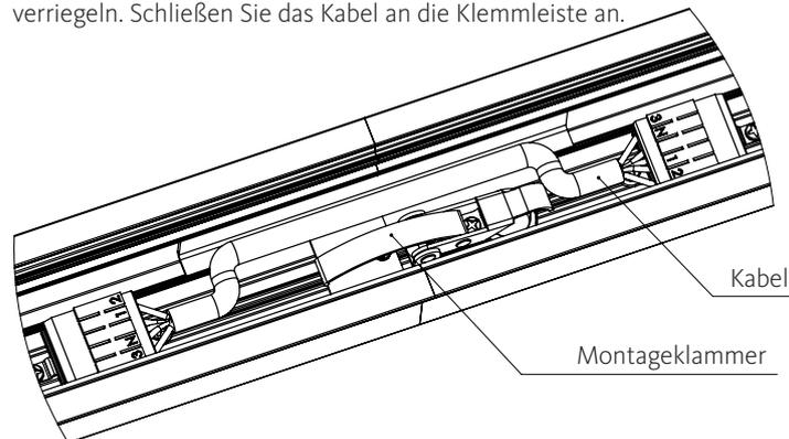
**5 a:** Ansicht des LED-Moduls im Querschnitt
