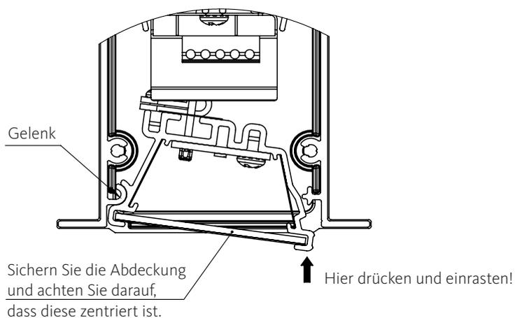
**5 b:** Halten Sie bei der Montage des LED-Moduls die innenliegenden Kabel fern!
