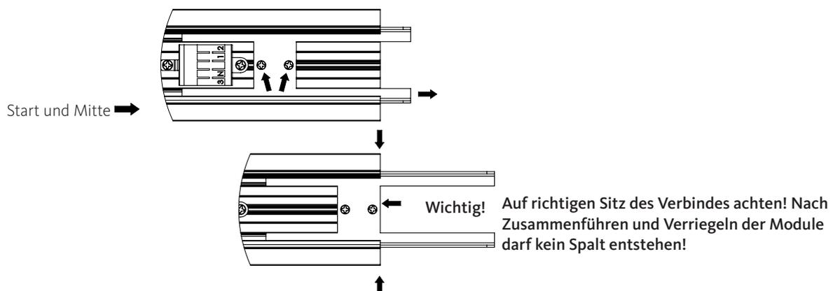
**3 a:** Montieren Sie das Startmodul gemäß der Anleitung für Sevede RE Standard.
