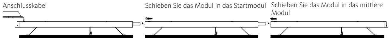
**4:** Verbinden Sie die Module, indem Sie die Montageklammer verriegeln. Schließen Sie das Kabel an die Klemmleiste an.
