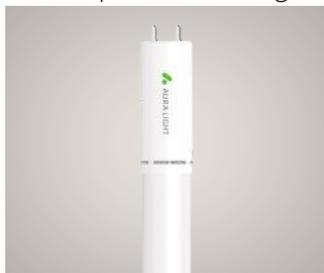
Die Aura Opti T8 HF Long Life ist eine energieeffiziente LED-Lampe für den Direktaustausch von T8-Leuchtstofflampen an einem elektronischen Vorschaltgerät. Die Lampe besteht aus einer hochwertigen Glasröhre mit einem PET-Splitterschutz und kann mit einem kompatiblen, für die Sicherheitsbeleuchtung zertifiziertem, Vorschaltgerät (184-264VDC) betrieben werden.
