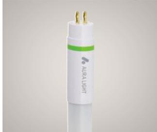
Aura Opti T5 HF Long Life ist eine LED-Lampe für den Direktaustausch von T5-Leuchtstofflampen am elektronischen Vorschaltgerät. Die Lampe besteht aus einer hochwertigen Glasröhre mit einem PET-Splitterschutz und ist notstromtauglich (194-264VDC) in Verbindung mit einem kompatiblen, notstromtauglichen Vorschaltgerät.
