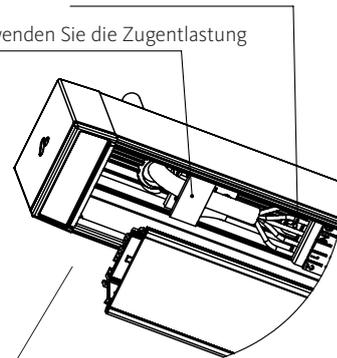
6 a: Optionale seitliche Kabeleinführung durch Bohren eines Lochs von 10mm gemäß Abbildung
