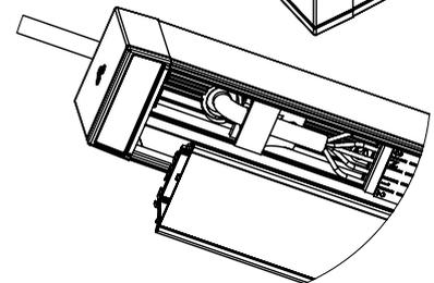
7: Montieren Sie das innere Profil des Leuchteneinsatzes
