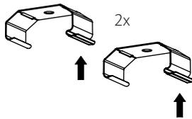
Achten Sie darauf, dass die Deckenhalter bei der Montage in dieselbe Richtung zeigen
