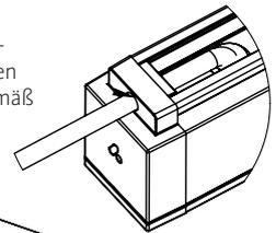
6 b: Verbinden Sie das Kabel inkl. Zugentlastung unter Einhaltung der Biege-Radien mit dem Anschlussblock
